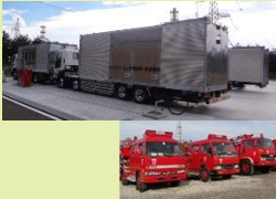
ガスタービン発電機車・消防車の配備
