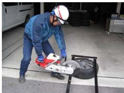
大型瓦礫を切断するためのエンジンカッター
