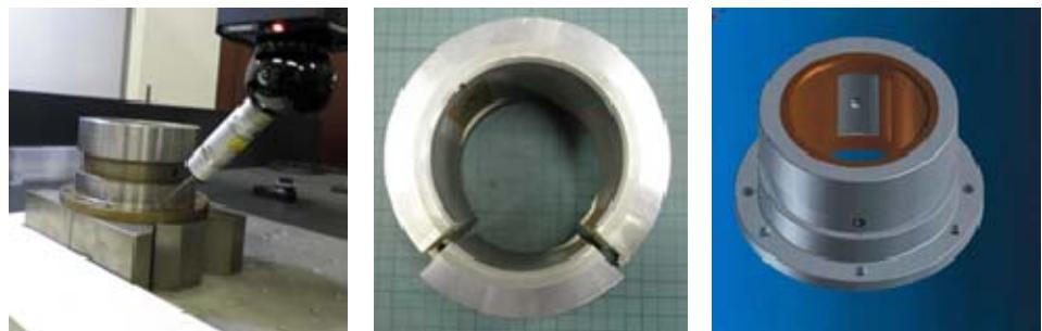
リバースエンジニアリングによる空調機部品（軸受け）の設計・製造
