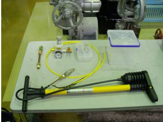
直営力情報共有会議における柏崎刈羽の改善事例の共有 (左：操作用空気喪失時の弁開閉ツール、右：ツールを用いた空気作動弁の開閉実演)
