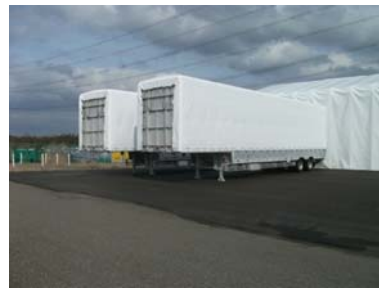
代替熱交換器設置時間短縮のための資機材積載トレーラーの配備（柏崎刈羽）
