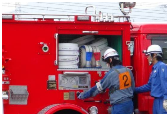
消防車接続訓練（左：ポンプ昇圧操作、右：ポンプ車による送水の開始）
