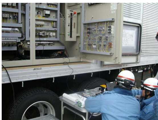
柏崎刈羽におけるガスタービン発電機の故障診断訓練 （左：制御車のシーケンスロジック確認、右：ガスタービン車の制御パラメータ確認）
