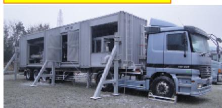
原子炉等の冷却水を海水で冷やす設備の代わりとなります。
