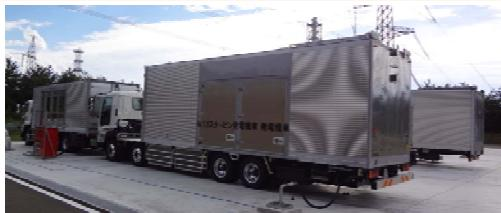
高台で、軽油の燃焼ガスでタービン（羽根車）を回して電気を作ります。制御車と発電機車で1セット。
