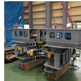
鉄塔解体装置（主柱材用）
