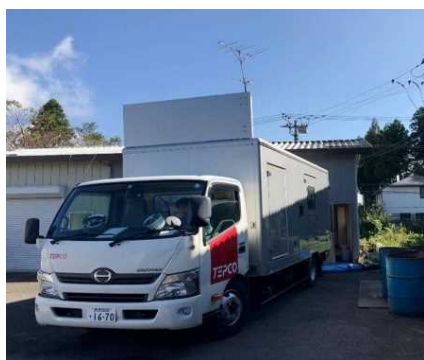
柏崎刈羽の電源車による給電
