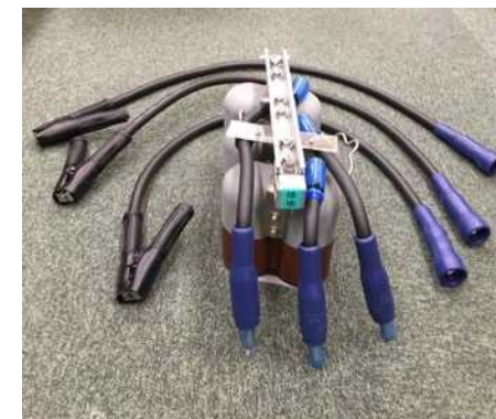
作成した専用工具（接地蓋）全景
