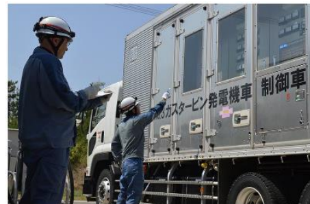
空冷式ガスタービン発電機車起動訓練
