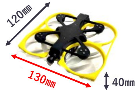
マイクロドローン (小型で軽量なドローン)
